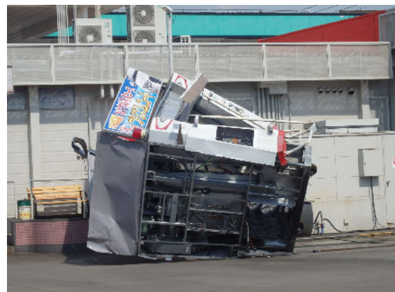
■ 写真 6 転倒した洗濯機
