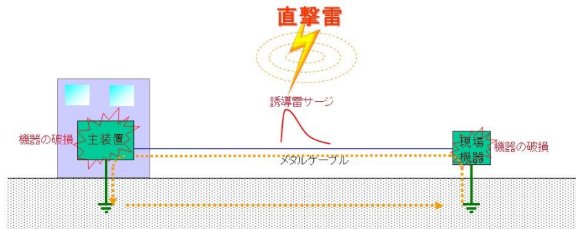
■ 図6 誘導雷がもたらす雷被害イメージ
