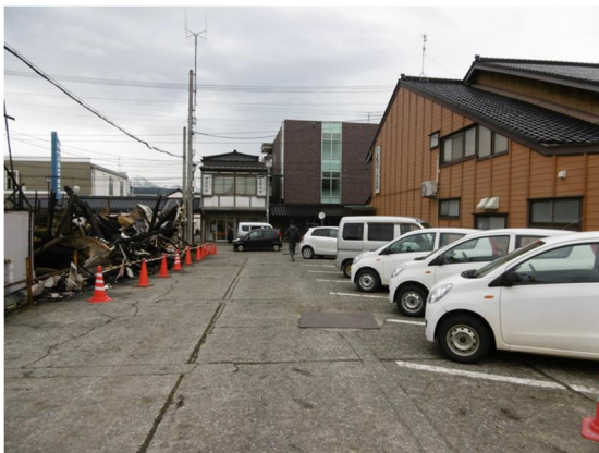
■写真5 空地（駐車場）が設けられた店舗 (左手方向からの延焼を防止)
