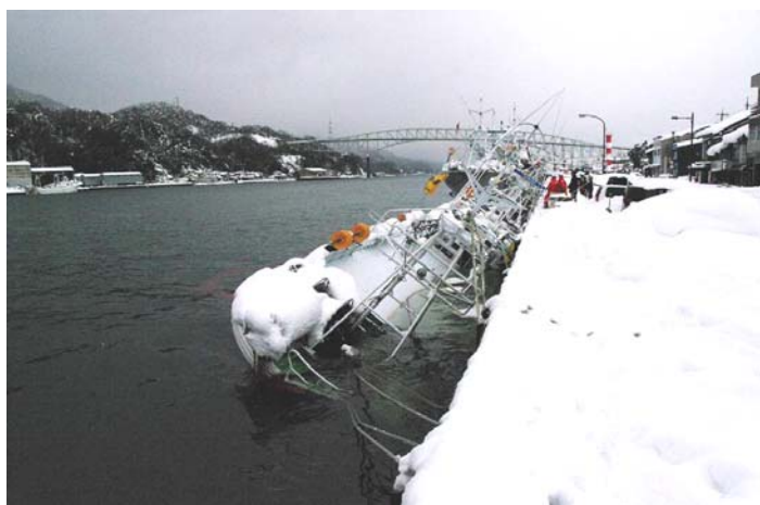
大雪で傾き浸水した漁船（写真提供：境海上保安部）
