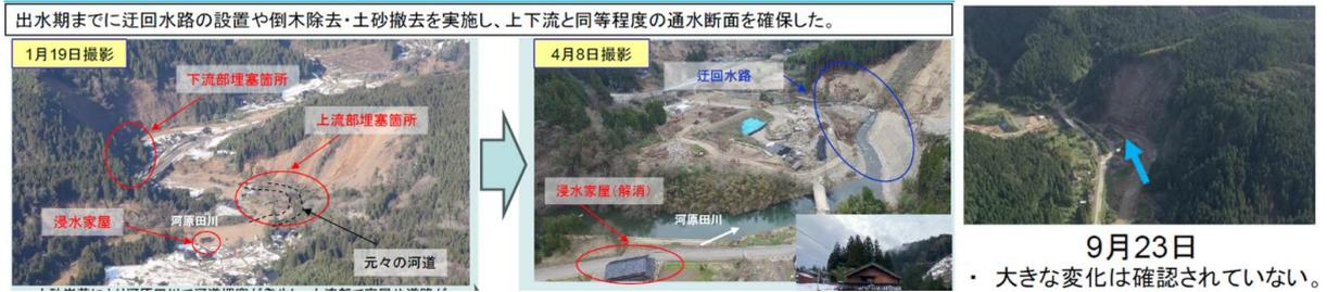
図 3 河原田川における能登半島地震への応急処置<sup>7</sup>と大雨後の様子<sup>8</sup>
